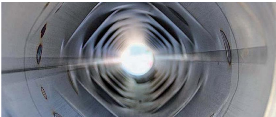
Figur 5 Spillvattenvärmeväxlaren är utförd med bucklor på det inre röret, antagligen i tron att det ska öka turbulensen och därmed värmeöverföringen. Bild från spuab.se
