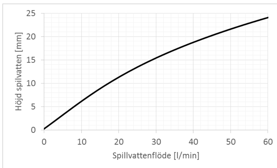
Figur 32 Flödet som funktion av spillvattenytans höjd.
