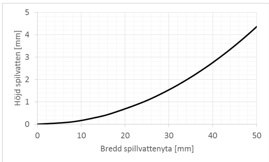
Figur 27 Spillvattenytans teoretiska bredd som funktion av höjden på spillvattenytan.
