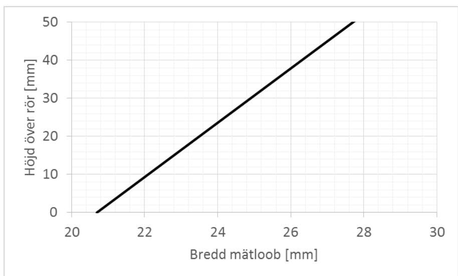
Figur 28 Mätloobens bredd som funktion av ultraljudsmätarens placeringshöjd över röret.
